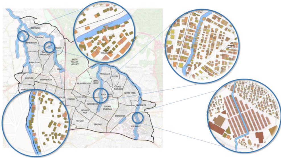
Şekil 30. 10 metrelik dere koruma bandı içerisinde yer alan yapılaşma alanlarının gösterimi
