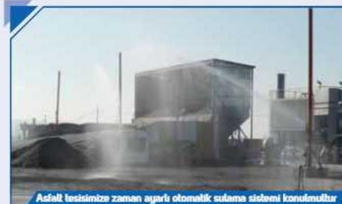
Asphalt tesisi'ne zaman ayarlı otomatik sulama sistemi konulmuştur
