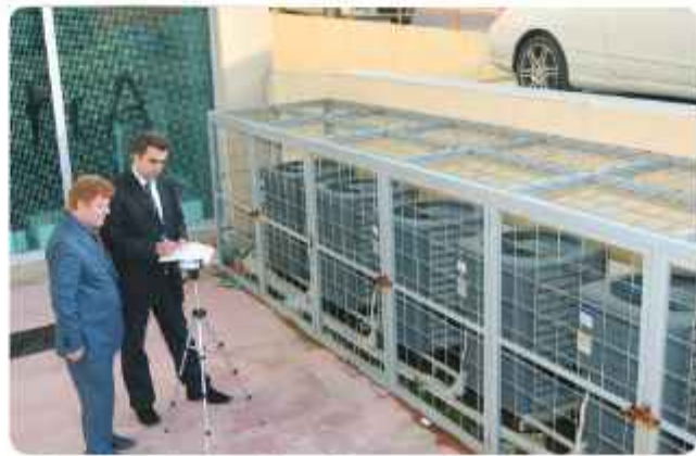
» Gürültü ve Vibrasyon Ölçüm Cihazı, gürültü ihlalleri denetimlerinde kullanılmaktadır. Cihazın aynı anda titreşim ölçebilme ve gece ölçümlerine uyumluluğu mevcuttur.
