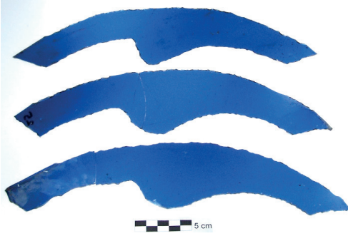
Resim 12: Kenarları Çentiklenmiş Dökme Düz Cam
