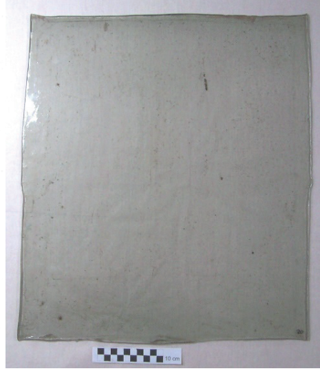
Resim 10-11: Dökme Düz Cam (Çizim: İ.U.Çelik)
